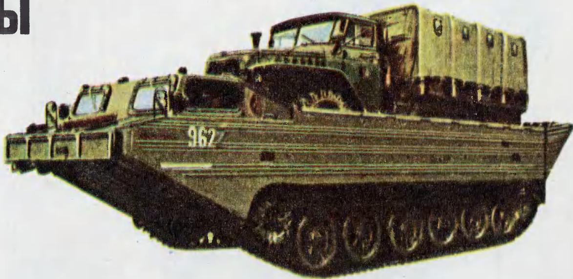
Плавающий транспортер ПТС с автомобилем «Урал—375» на платформе.
